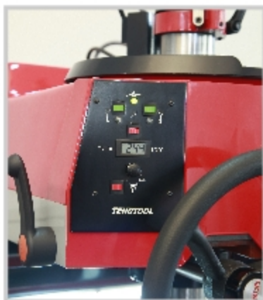
主轴控制面板 Spindle control panel
