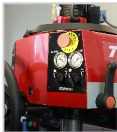
气路控制面板 Air control panel
